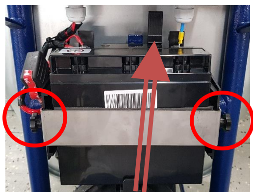
obr. 7. - odpojení akumulátoru z držáku uvolnění šroubů a držáku aku.
