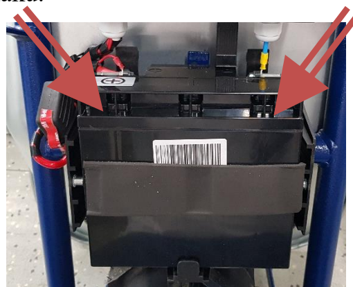
obr. č. 8. - označení místa, kde se odšroubuje akumulátor od vodičů
